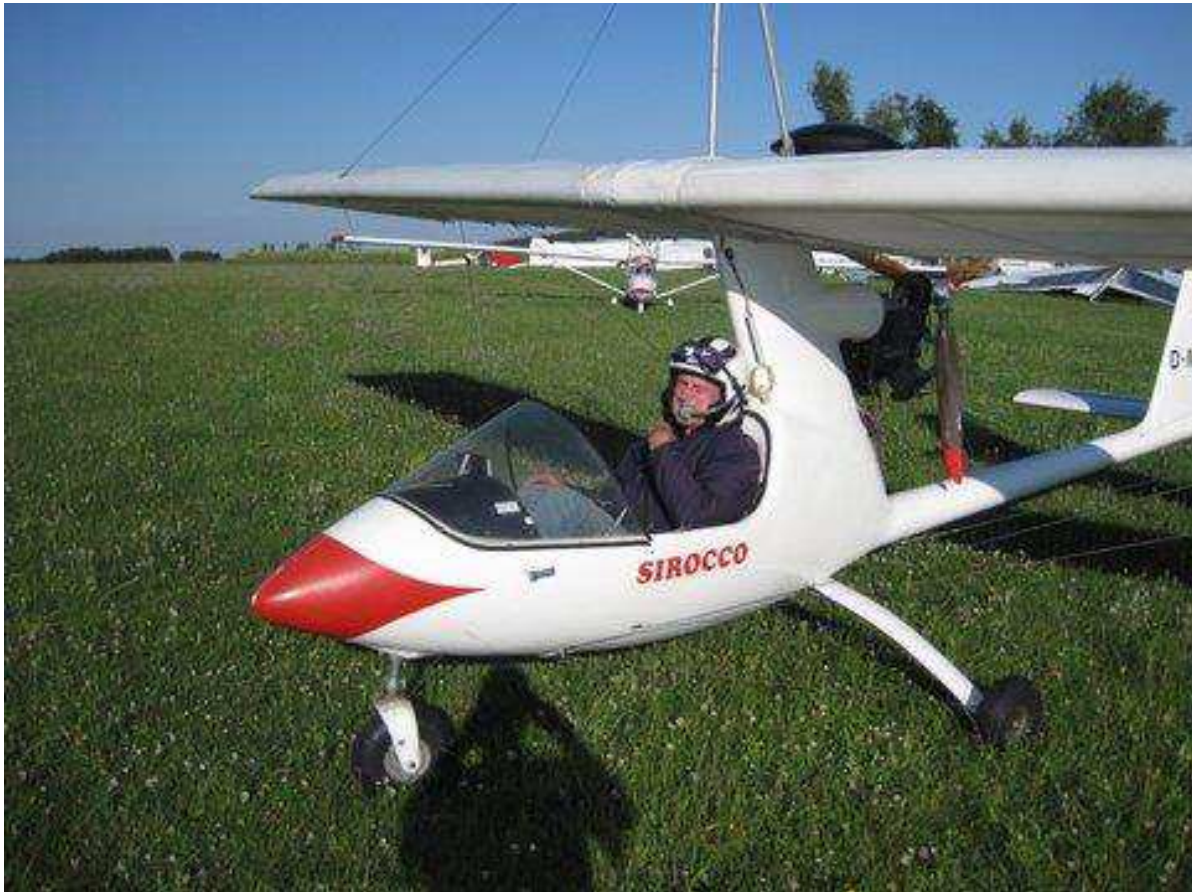
Aerodynamisch gesteuertes Ultraleichtflugzeug: Aus Bausatz selbst gefertigt
