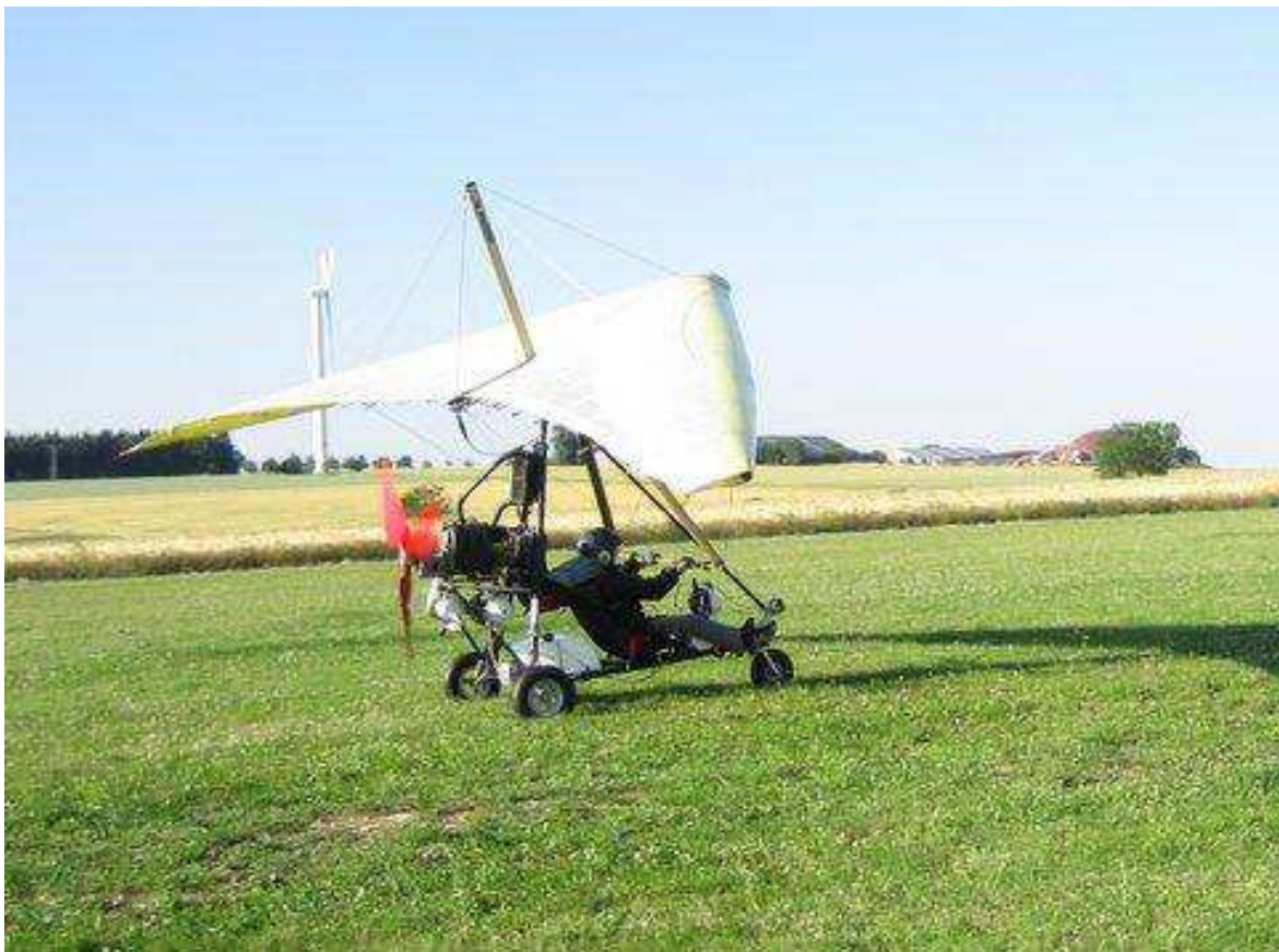
Gewichtskraft gesteuertes Ultraleichtflugzeug: Motorisierter Drachen mit Trikegestell
