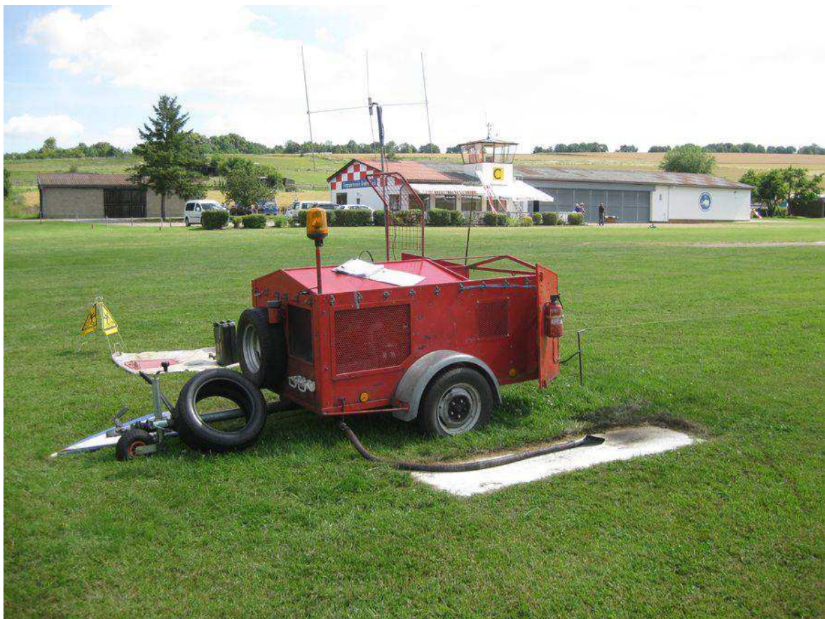
Hydraulische Schleppwinde der Drachen- und Gleitschirmflieger Heilbronn e. V.
